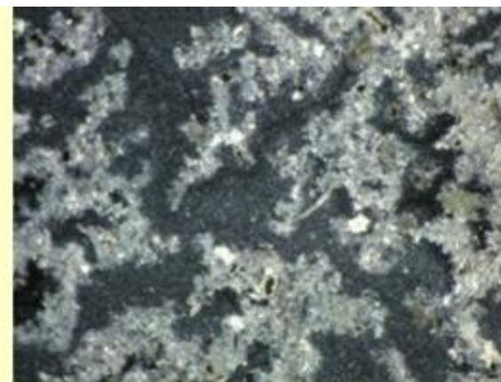
水解后的污泥：其凝胶结构被打破，凝胶在后续处理中被降解。
