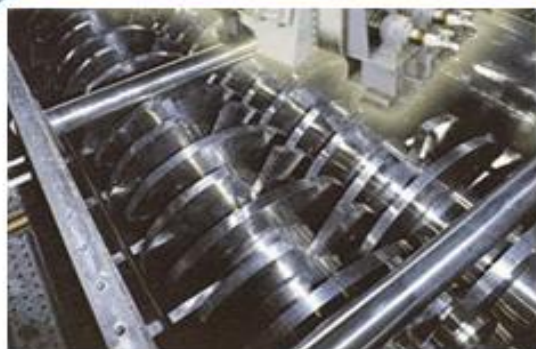
日本.....公司桨叶式干化机内部结构图，设计倾斜式，实际运行会加大磨损，温州项目上出现穿孔现象。
