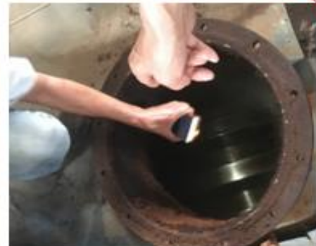
绿水公司桨叶式干化机内部结构图，设计契型及刮泥结构，上两图实际运行 5 年的项目未出现磨损穿孔、或堵塞等现象。
